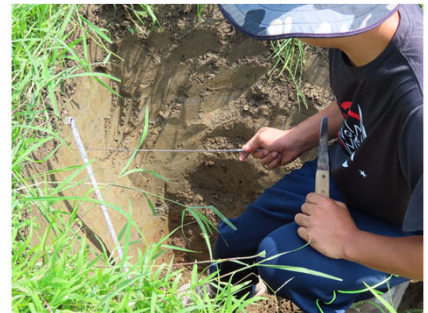
圖四、使用穿刺棒檢查土壤硬度。
