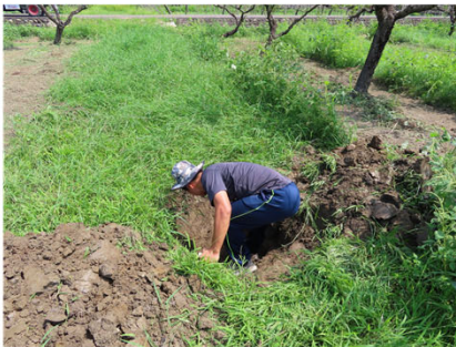
圖二、首先選擇最具代表性的地點，用鐵鏟開挖土坑，約1米深、1米寬
